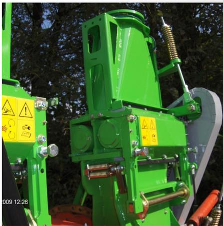
Hydraulische Turmbedienung und Erhöhung der Abwurfhöhe auf 5,3m gewährleisten einen bequemen Einsatz bei großen Abfahrwagen und einen sauberen Strahl zum Überhäckseln.
