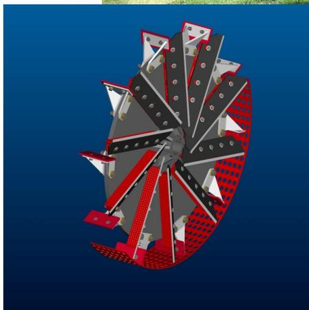
Der Scheibencracker ist der Garant für hundertprozentige Körnerzerkleinerung, auch bei großen Häcksellängen ohne leistungszehrende Reibböden oder Zahnschlagleisten. Nur ca. 15 kW Leistungsbedarf !
