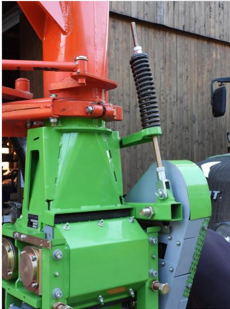
Reinigungsclappen und sehr gute Zugänglichkeit ermöglichen einen schnellen Wiedereinsatz bei eventuellen Verstopfungen oder bei Reinigungsarbeiten
